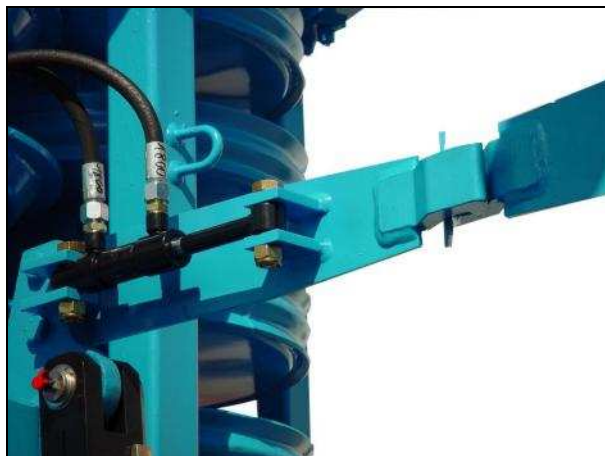
Az oldalelemek és hengerek hidraulikus szállítási rögzítése
