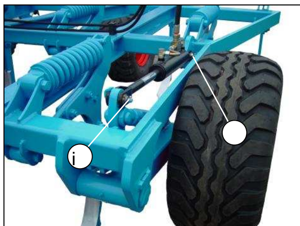
j) A támkerekek hidraulikus hengere
