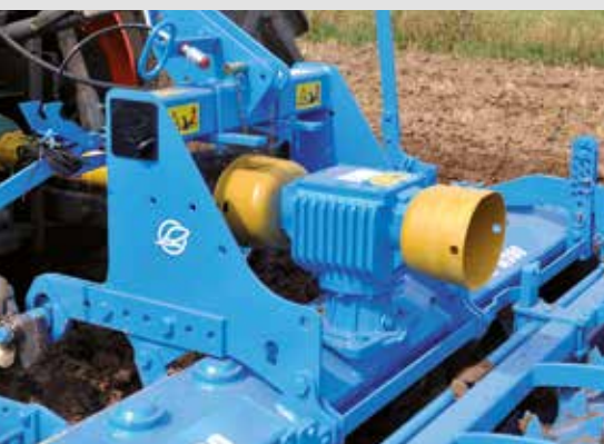
Egyszerű erőátvitel a cserekeres hajtóművel
