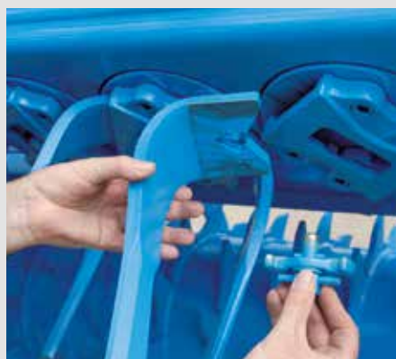
A fogak cseréje a gyorscsereős rendszer segítségével
